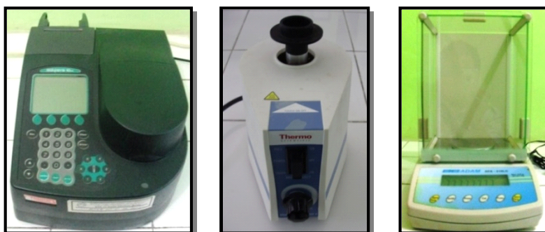
Gambar 3. Beberapa Alat Untuk Analisa Ammonium Di Lab Kimia Air BP2KSI (a. Spektrofotometer Thermo Genesys 10UV, b. Vortex Mixer Thermo, c. Neraca Analitik ADAM AFA– 210LC).
