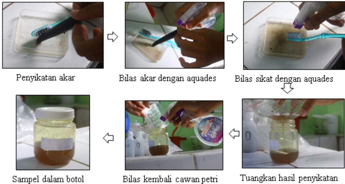
Gambar 4. Alur penanganan sampel perifiton di laboratorium
